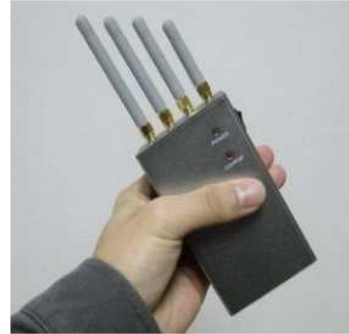
Bloqueador Celulares+gps+wifi Equipo 120B Pro Freq; 850-960mhz,1805-1990mhz,gps,Wifi. Bloqueo 15 metros. Peso 0.5 kgs.
