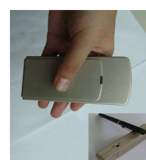
Bloqueador Gps Modelo 130C Freq.1500-1600mhz(gps l), 1200-1300(gps-l2) Bloqueo 8 mts.0.4watts <=-75dbm. Peso 0.25 kgs.
