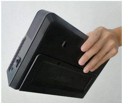
Bloqueador Celulares Modelo 101I Freq1. 850-894,925-960,1805-1990,2100-2170 Freq2. CDMA, GSM,3G,GPS 10W. Bloqueo 30 metros. Peso 1.27kgs/pc.
