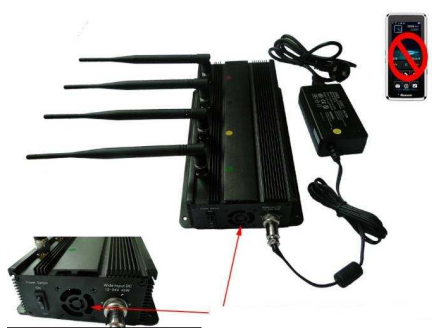
Bloqueador Celulares Modelo 101I Freq1. 850-894,925-960,1805-1990,2100-2170 Freq2. 925-960, 1805-1880, 2100-2170mhz 10W. Bloqueo 40 metros Peso 2.5 kgs
