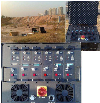
Bloqueador Celulares/Wifi/GPS GSM800-900:800-960,1800:1805- 1880,1900:1920-1990,3G:2110-2170 GPS: 1500-1600,Wifi:2400-2500. 600x630x600mm, 360Watts. 100-500 metros(depene señal en el area).
